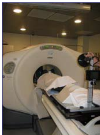
afb. 1 De tracking camera achterop de radiotherapieplank bevestigd. D.m.v. de ring wordt scherpgesteld op de reflectoren.
