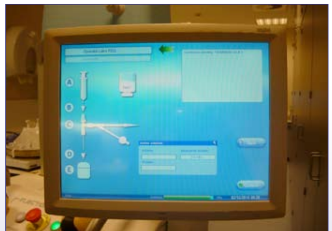
Figuur 2. De laadprocedure van de Posijet® in het hotlab wordt schematisch weergegeven op het scherm: A= 10 ml spuit waarin alle patiëntendosisen worden opgetrokken; C= disposable kit type 1; E= multi-dose 18 F-FDG vial
