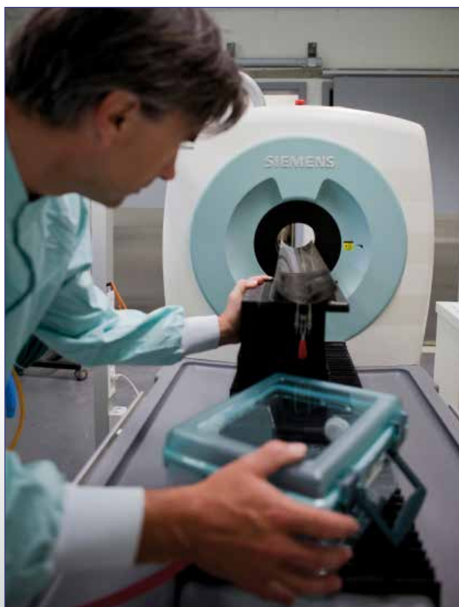
De preklinische onderzoeksgroep van MICA beschikt over 3 PET scanners die speciaal ontworpen zijn voor proefdieronderzoek. De preklinische scanners hebben een opening van 16 cm en een resolutie van 1.2 mm.
