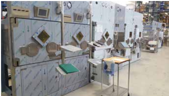
Hot cells voor het GMP-PET-lab tijdens de Factory Acceptance Test (FAT) (mei 2017).
