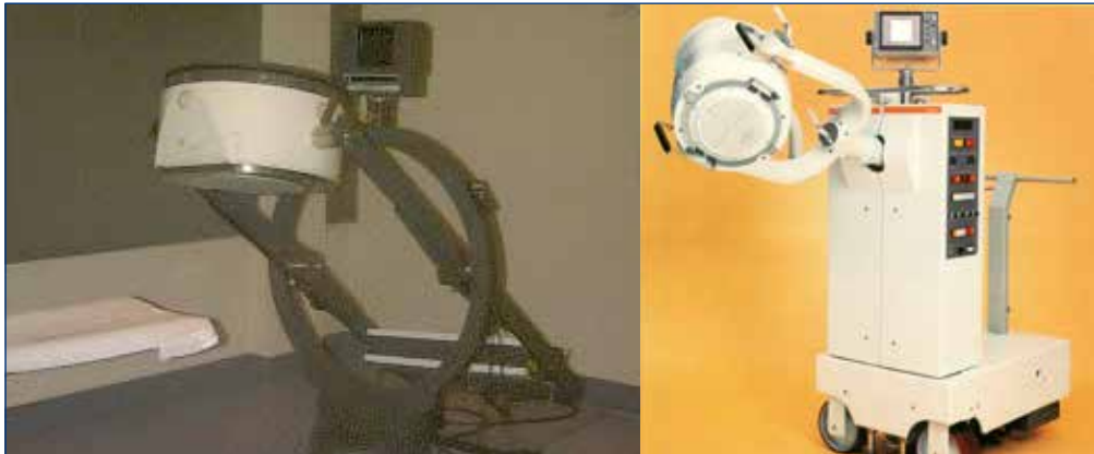
Figuur 5. Links de eerste roterende gammacamera (GE) en rechts de mobiele cardiac camera (Siemens).
