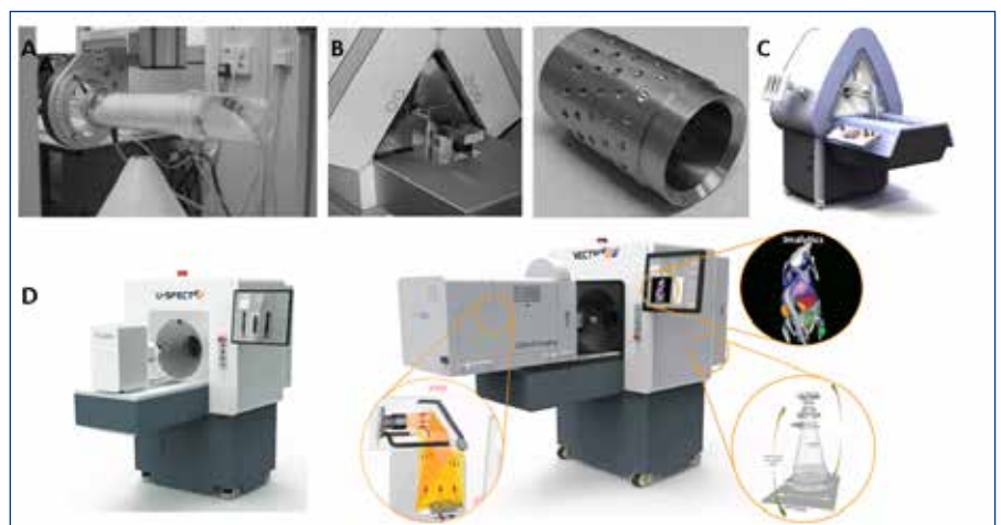
Figuur 1. Overzicht van in Nederland ontwikkelde scanners. (A) Pinhole-SPECT met roterend bed ontwikkeld in AMC (2001,(1)); (B) Prototype U-SPECT (U-SPECT-I) met cilindervormige multi-pinholecollimator (2005, (5)); (C) U-SPECT-II (2009); (D) Laatste versie VECTOR 6 PET/SPECT scanners gecombineerd met geïntegreerde CT en OI (2018, MILabs BV). In de U-SPECT en VECTOR-CT zijn detectoren en collimator geheel stationair.
