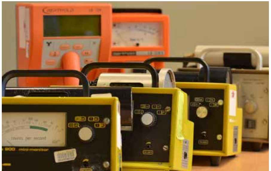
Apparatuur voor het meten van straling in een C-laboratorium (foto Wout Moerman, Radboudumc)
