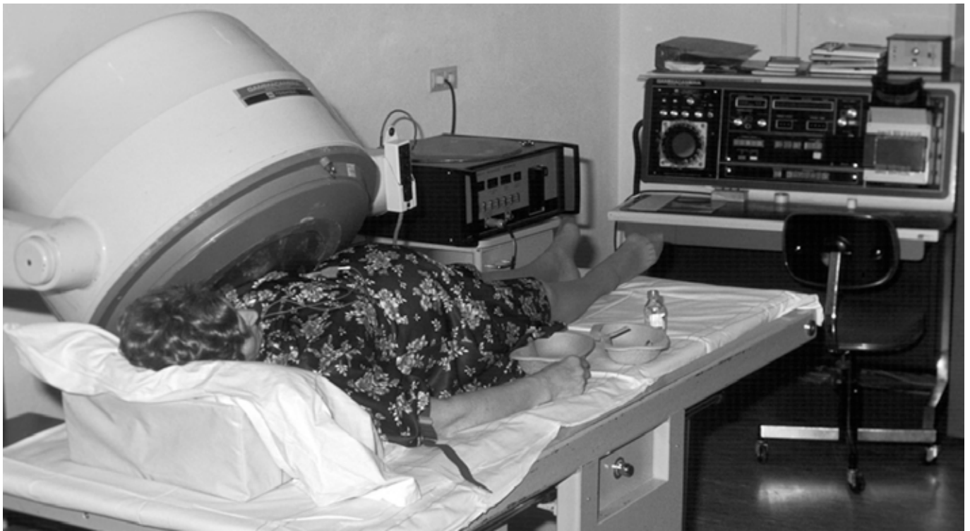
Grootveld cirkelvormige gammacamera met analoge beeldweergave gebaseerd op polaroidfoto's (rechts in de console) en persistence-scoop (1974).
