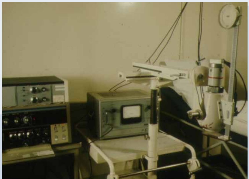
Afgeschermd scintillatiedetector voor externe orgaanmetingen.
