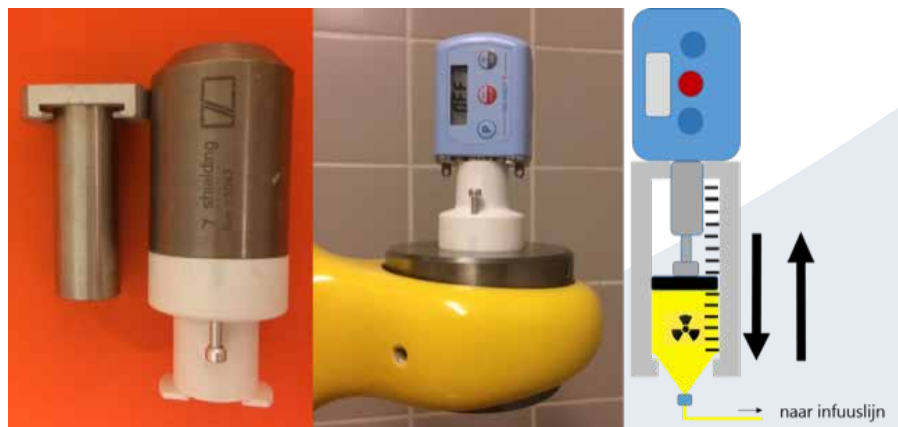
Figuur 3. Links een foto van een wolfram huls die gebruikt wordt voor injectie van ^{177}\text{Lu} therapieën in het UMC Utrecht. In het midden het gehele toediensysteem met toedienpompje (RAD-INJECT, Tema Sinergie, Faenza, Italië). Het pompje wordt op de wolfram huls geklikt en het geheel wordt in een gele paal opgehangen. Rechts een schematische weergave van dit systeem. De radioactiviteit bevindt zich in een plastic injectiespuit, het geheel omgeven door de huls van wolfram (lichtgrijs). Het uiteinde van de lijn wordt op een goed lopend perifeer infuus aangesloten. Het toedienpompje (blauw) wordt op het systeem geklikt, waarna de toediening gestart kan worden. Hiermee wordt alle radioactiviteit automatisch toegediend binnen een tijdsbestek van vijf minuten inclusief driemaal flushen van het systeem met NaCl 0,9% (46).
