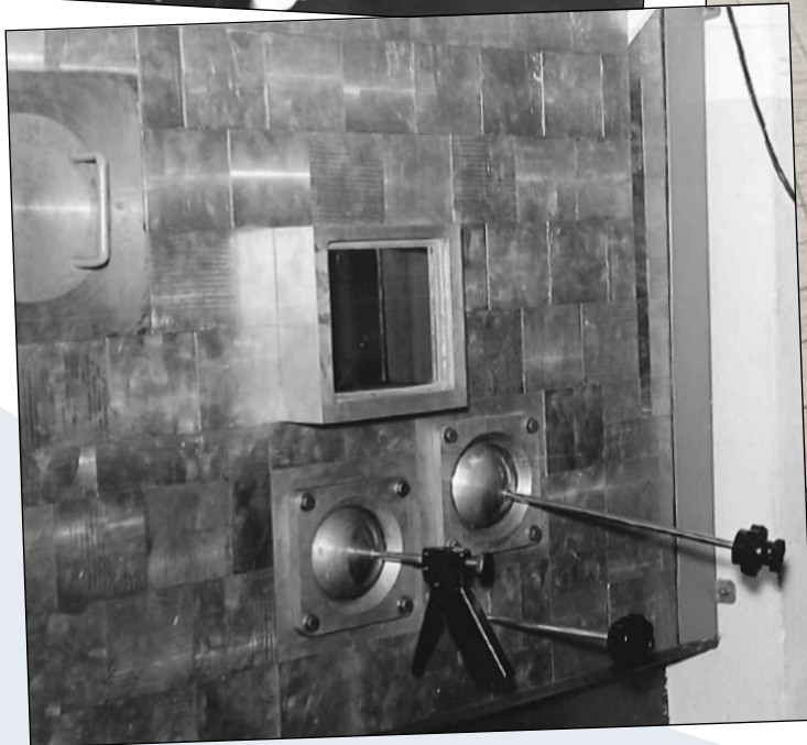
Links boven het hotlab voor de bereiding van radiofarmaca in Petten omstreeks 1965 met links onder een detail van de productiecellen opgebouwd uit loodblokken. Rechts het huidige hotlab. Modernisering gaat door maar handmatigheid blijft belangrijk! (fotomateriaal Edith Wesselink, Curium Pharma).
